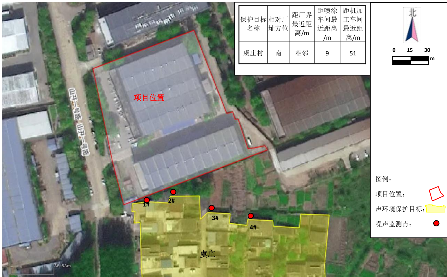
附图 3-1：声环境保护目标分布及声环境质量现状监测布点图
