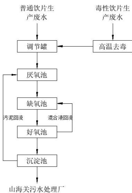
图 4.1 污水处理工艺流程图
