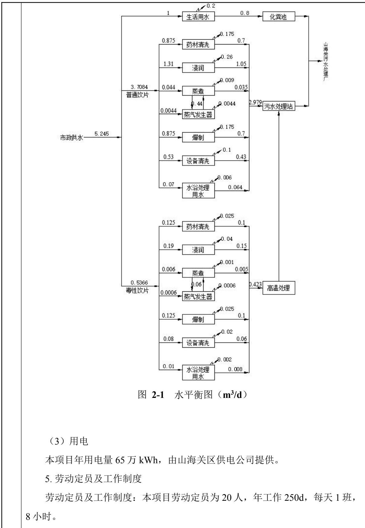
图 2-1 水平衡图 (m<sup>3</sup>/d)
