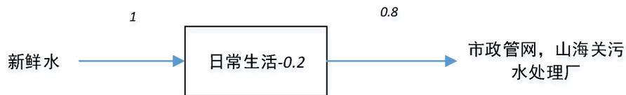
图 2-1 水平衡图 单位: m<sup>3</sup>/d
